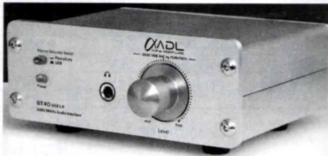
パソコンに保存したデジタル音源を高品位に再生するUSBオーディオインターフェース。フォノイコライザ内蔵で、本機を介してレコード音源のデジタルへの取り込みが可能。アナログ入力は背面スイッチでMC(0.5mV), MM(5mV), ライン(1V)に切り換えられる。96kHz/24ビット高性能DAC, USBバスパワーに頼らない専用外部電源, 本格ヘッドフォンアンプ搭載など、PCオーディオ機器としてついに造られている。
