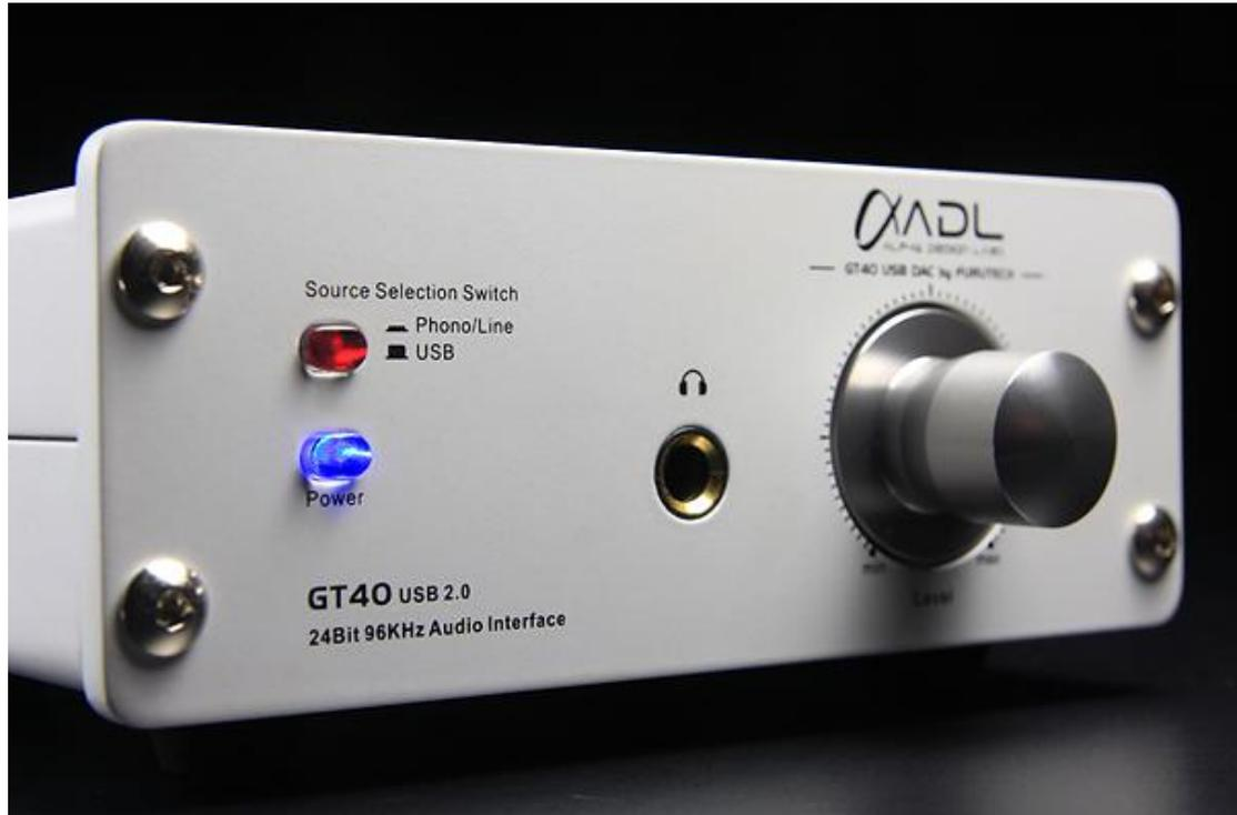
在外觀方面，GT40 的鋁質外殼表面是霧銀白色處理，不易沾染指紋，轉動音量旋鈕時的手感紮實，給人很好的印象，面板左側的電源鍵亮藍光時表示開機狀態，上方訊源鍵綠光代表 USB 數位輸入，紅光則代表 Phono/Line 類比輸入，整個面板就只有兩個按鍵和一個旋鈕而已，操作一點都不複雜。而背板端子也很單純，一組 USB 2.0 (Type B) 數位輸入、一組 RCA 類比輸入 (Line/MC/MM)、一組 RCA 類比輸出，全部都有鍍金處理，其中 RCA 端子還是採用 Furutech 的製品，至於則未配置。
