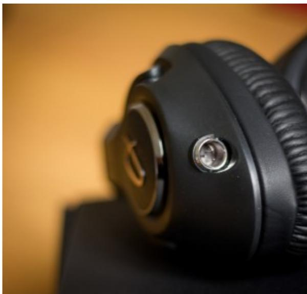
Le H118 a une connexion de type mini XLR et le mini-jack à 3 broches permet de changer de câble facilement. Le casque se plie facilement pour prendre un minimum de place.
